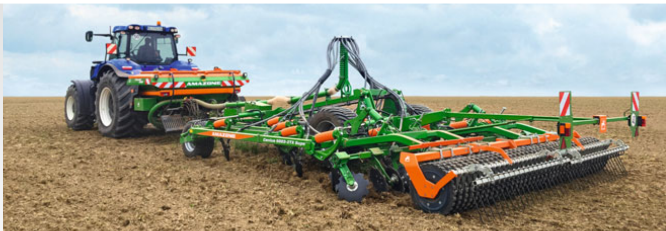
XTender 2200 ar Cenius 5003-2TX un vienu padeves kanālu mēslojuma izsēšanai
