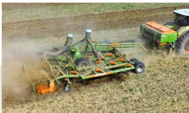
XTender 4200 ar Cenius 6003-2TX un diviem padeves kanāliem mēslojuma un sēklu izsēšanai
