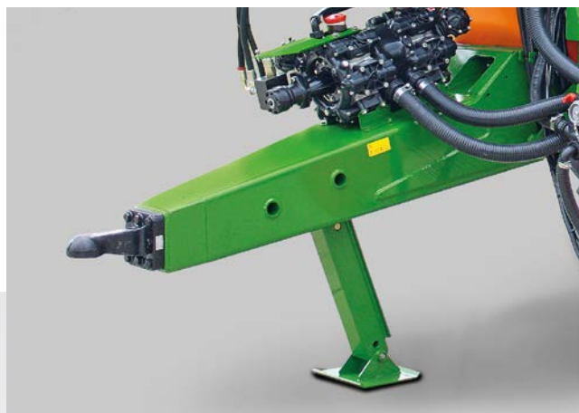
Apakšējā sakabe ar K80 sakabes ierīci ar lodveida uzgali un hidraulisku balsta kāju
