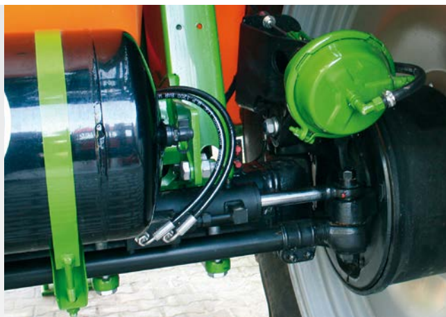
AutoTrail ass šarnīra stūres iekārta
