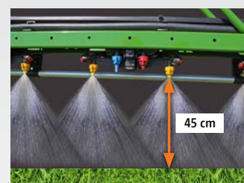
80° sprauslas: attālums starp sprauslām 25 cm
