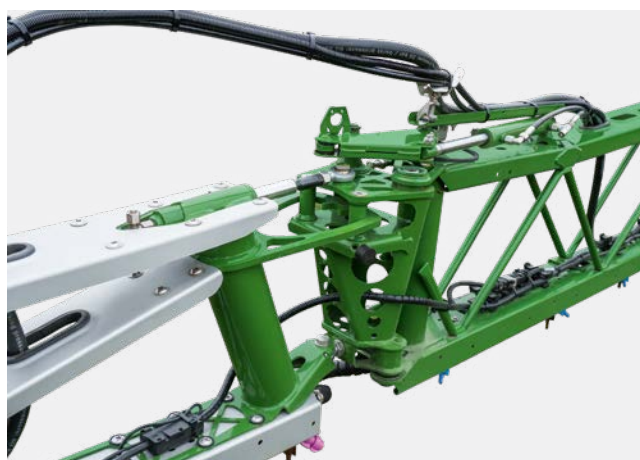
36 m Super L3 stieņu sistēma, samazināma līdz 24 m un 12 m
