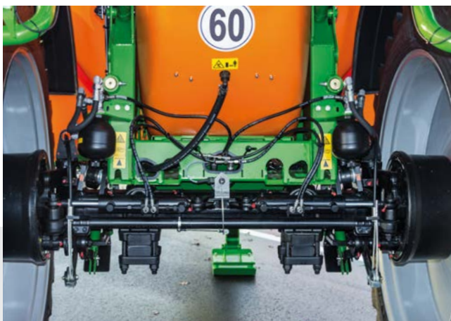
Hidropneimatiskais ass atsperojums ar AutoTrail ass šarnīra stūres iekārtu
