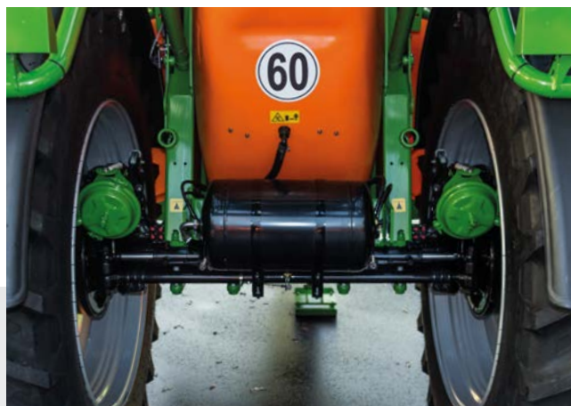
AutoTrail ass šarnīra stūres iekārta
