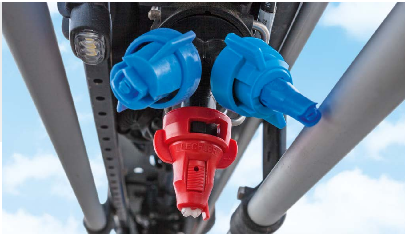
AmaSwitch 3-vietīgais sprauslu turētājs ar atsevišķu sprauslu LED apgaismojumu
