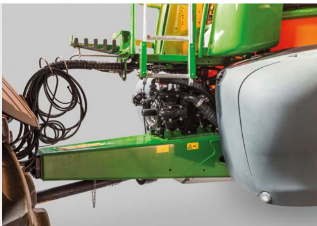
UX 4201 Super, UX 5201 Super un UX 6201 Super dubultā sūkņa sistēma nodrošina iesūkšanas ražīgumu līdz pat 700 l/min
