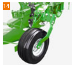
Ritenis, Ø 680 mm, piepūšamas riepas x 250 mm platums – smags izpildījums (ar divkāršu statni) Pieejams šādiem modeļiem: visiem 6 lemešu, kā arī 5 lemešu S un/vai V arkliem
