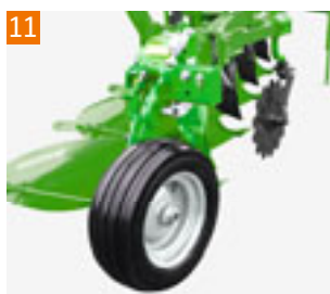
Ritenis, Ø 600 mm, piepūšamas riepas x 220 mm platums Pieejams šādiem modeļiem: M/XM/XMS/XS (nav piemērots 6 lemešu, kā arī 5 lemešu S un/vai V arkliem)
